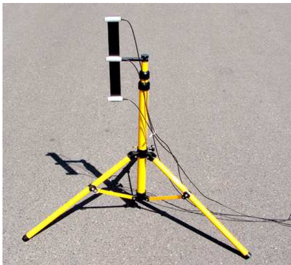
Abbildung 2: 3 UAP-Sonden auf Stativ
