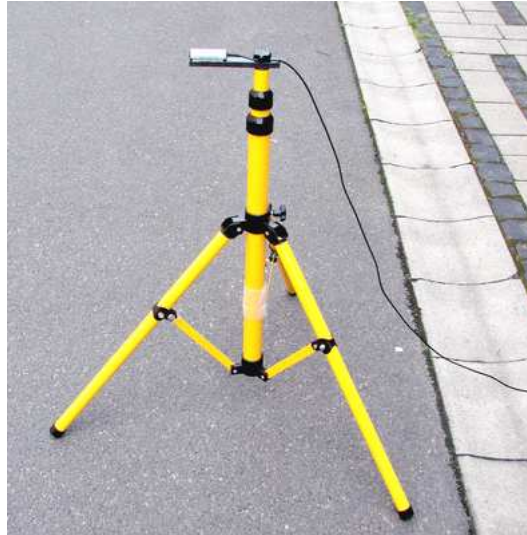
Abbildung 1: UAP-Sonde auf Stativ
