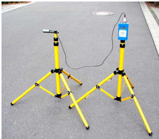
Abbildung 4: UAP-Sonde und FM 205 auf Stativ
